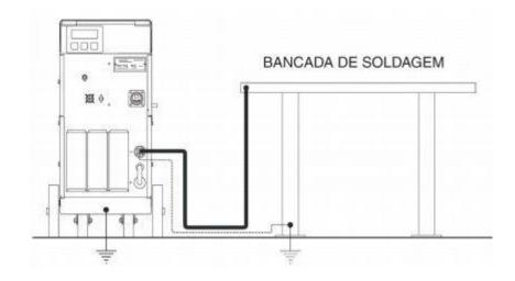
Antes de iniciar a máquina de solda, verifique se os cabos, interruptores, botões de controle, cabo "terra" e o suporte do eletrodo estão em boas condições. Examine as garras do suporte do eletrodo e verifique se estão firmes, seguras e em boas condições para garantir um bom contato com o eletrodo. Verifique também se as conexões são apertadas, pois uma conexão fraca com o suporte do eletrodo causa superaquecimento e queima as mãos.
