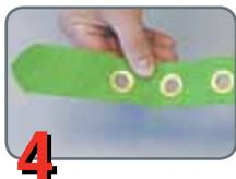
**4) Lingueta/olhais** – a lingueta fica bastante gasta devido ao constante afivelamento e desafivelamento. Verifique se há olhais soltos, deformados ou quebrados. O cinturão não deve ter punções adicionais.
