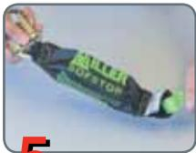
**5) Pacote de absorvedor de impacto** – a parte externa do pacote deve ser examinada quanto a furos de queima e desgaste. As costuras nas áreas em que o pacote é firmado a cintos ou talabartes devem ser examinadas quanto a feixes soltos, rasgos e deterioração.
