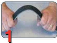
**1) Cinturão** – usando as mãos, afaste a trama cerca de 20cm. Dobre-a em forma de “U” invertido como mostra a figura. A tensão superficial resultante torna mais fácil detectar fibras danificadas ou cortes. Repita este procedimento por toda a extensão do cinturão, verificando ambos os lados de cada fita (cadarço). Procure bordas gastas, fibras rompidas, costuras abertas, cortes, pontos queimados e danos químicos.
