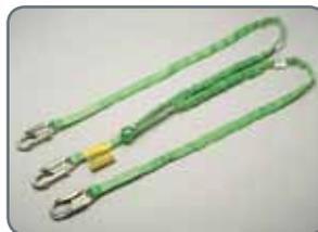
Se uma das “pernas” do talabarte duplo (com pacote absorvedor de impacto ou absorvedor de impacto tubular) não for usada, ela não deve ser fixada a nenhum item permanente do cinturão, tal como os elementos de conexão laterais. Isto faz com que o absorvedor não funcione corretamente, criando um risco.
