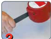
**3) Mecanismo de frenagem** – o mecanismo de frenagem deve ser testado segurando-se a linha retrátil acima do indicador de impactos e aplicando-se um empuxo firme para baixo, que irá engrenar o mecanismo de bloqueio. Não deve ocorrer deslizamento da linha de segurança enquanto estiver bloqueada. Uma vez liberada a tensão, o bloqueio irá desengatar e a unidade retornará ao modo retrátil. Não use a unidade se o bloqueio não funcionar corretamente.
