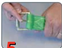
**5) Lingueta** – a lingueta deve estar livre de distorções, tanto no formato quanto no movimento. Deve se sobrepor à moldura da fivela e se mover para a frente e para trás no suporte. O rolete deve girar livremente na moldura. Verifique se há deformações ou cantos vivos.
