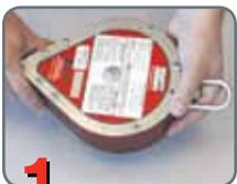
**1) Verifique o invólucro** – antes de cada uso, verifique o invólucro da unidade quanto a presilhas soltas ou dobradas, rachadas, deformadas, gastas, com falhas de funcionamento ou com partes danificadas.
